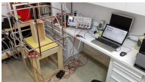
Figura 1. Sistema de medida del momento magnético. Configuración con dos magnetómetros 3D.
