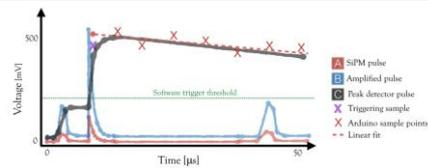
Fig 2. Análisis temporal de los eventos y señales producidas en un centelleador.
