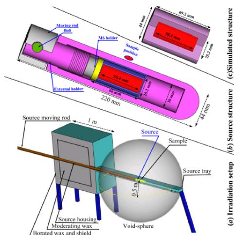
Utilizaremos MCNP para determinar los materiales y sus espesores capaces de mantener los niveles de radioactividad dentro de los límites marcados por el Consejo de Seguridad Nuclear. En la Figura 1 se muestra un ejemplo de este tipo de contenedores que deben de disponer de sistemas de extracción adecuados de la fuente AmBe para la realización de experimentos.
