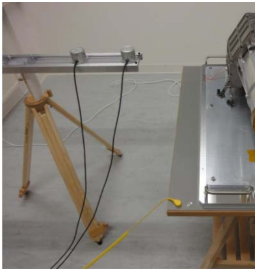
Figura 1. Sistema de medida del momento magnético. Configuración con dos.
