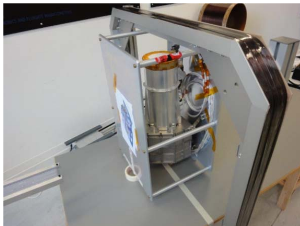
Figura 2. Medida de la inducción producida por un campo externo sobre el producto electrónico.
