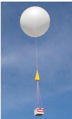
La altura a la que se eleva un globo estratosférico durante un vuelo se puede medir de manera directa a través de un altímetro basado en un sensor barométrico o mediante un GPS especial de elevado coste [1]. Las limitaciones COCOM [2] referidas al seguimiento GPS establecen que no se pueden superar la velocidad de 1900 km/h y una altitud mayor de 18000 m.
