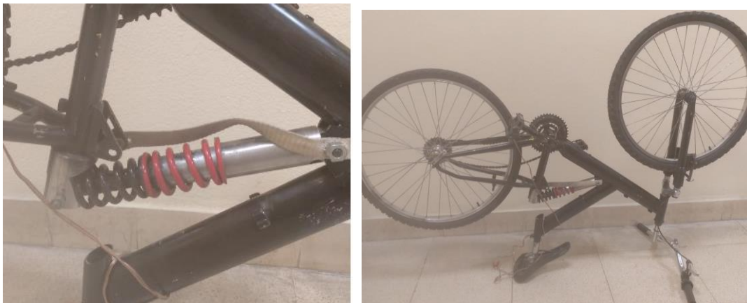
Fig. 5. Amortiguador implementado en bicicleta
