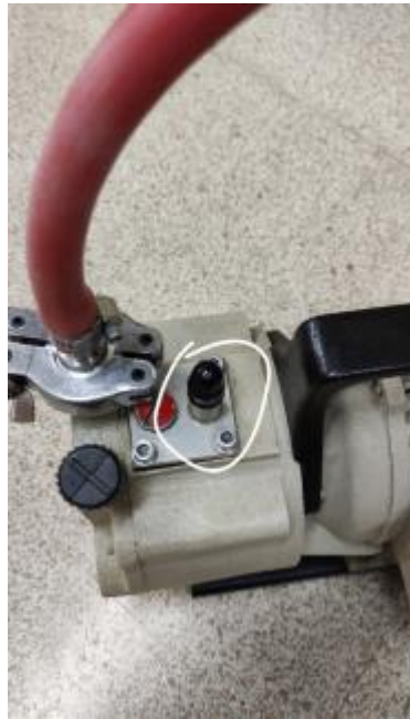
Fig 3. Bomba de vacío para evitar que las partículas de baja energía se desvanezcan por la interacción con el aire.
