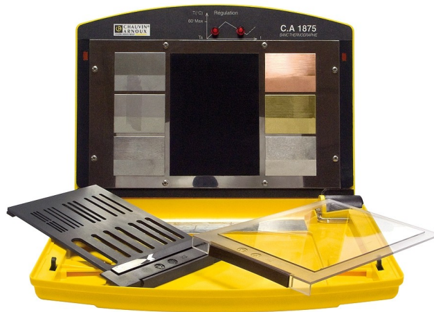
Fig 2. Panel de caracterización de emisividades de diferentes superficies metálicas.
